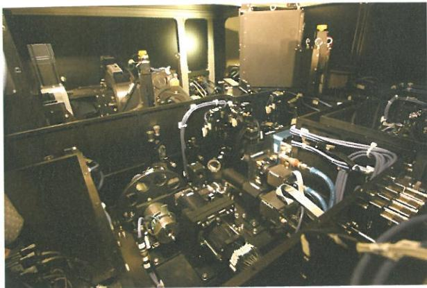
図2 188素子補償光学装置の内部。手前は大気ゆらぎの影響を測定するための波面センサー。
